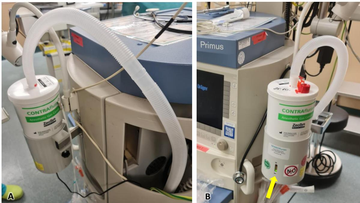
**Abb. 1** Aktivkohlefilter CONTRAfuran™ an Dräger Primus. **A:** seitliche Ansicht mit Schlauch. **B:** frontale Ansicht, das grüne Licht (gelber Pfeil) signalisiert einen aufnahmefähigen Filter mit ausreichend freier Kapazität.
